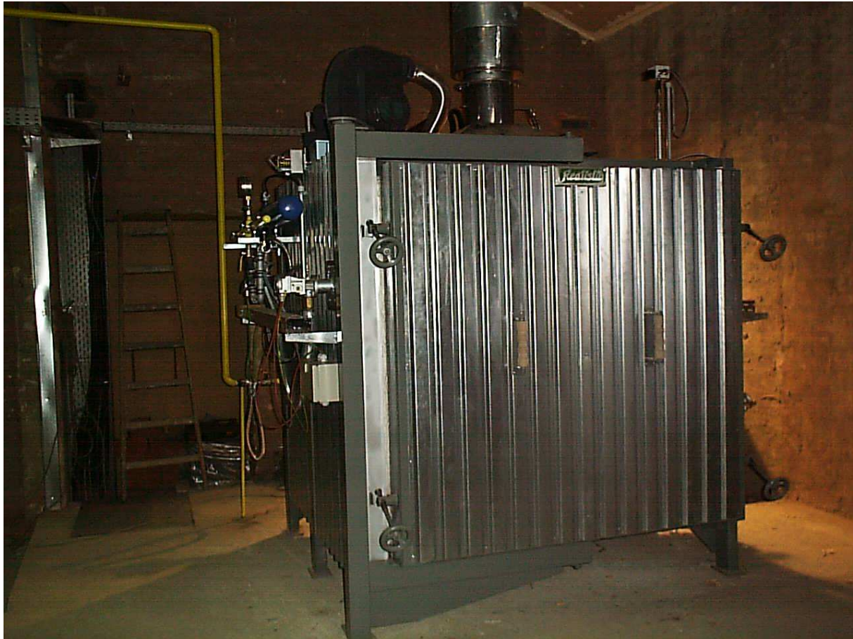
Kammerofen für Laboreinsatz Dachziegelproduktion Glasurbrände.
