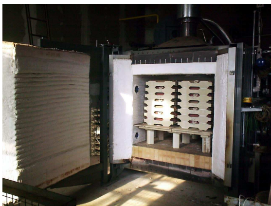
Nutzraumaufbau Dachziegel in Feuerfestkassetten mit einer Nutzauslastung von ca. 1,1 m 3 .
