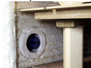
Overbrenner Hegwein ZG0 mit dezentraler Flammenüber- wachung im Impulsbetrieb mit Brenngasstrahlmodulation BBM 0-400 Impulse/min.
