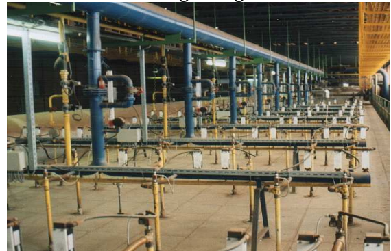
Injektor - Deckebrenngruppen im Hauptfeuerbereich mit Einzelimpulsventilen an jeder Brennerlanze und Impulsbetrieb (BGS-Modulation) von 0-450 Imp./min.
