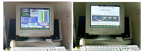
Bild 16-19: vollgraphische Leitstandvisualisierung zum Bedienen- Beobachten- und Archivieren der kompletten Tunnelofenanlage.
