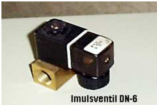
Bild 10: Spezial-Impulsventil DN 6-9m 3 /h > flüßig.-u.gasförmige Medien< max.Impulsfrequenz > 0-1000 Impulse/min.< Druckbereich > Pmax. 1.2 bar< Spannung/Strom > 24V DC/ 0,37 A< Arbeitstemperatur > -10 bis + 90°C<
