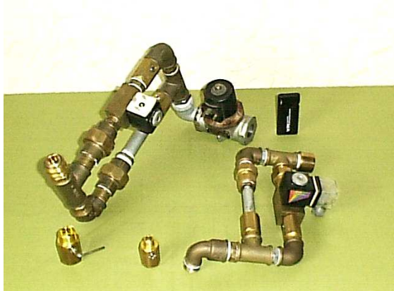
Bild 9: Impuls- Zündlast- Bypass DN 6-9m 3 /h mit Ballofix Feineinstellventilen zur Durchflussmengenregulierung von Zünd- und Impulslastbetrieb für Hochgeschwindigkeitsbrennaggregate die unterhalb der Zündtemperaturgrenze zum Einsatz kommen. (DVGW)
