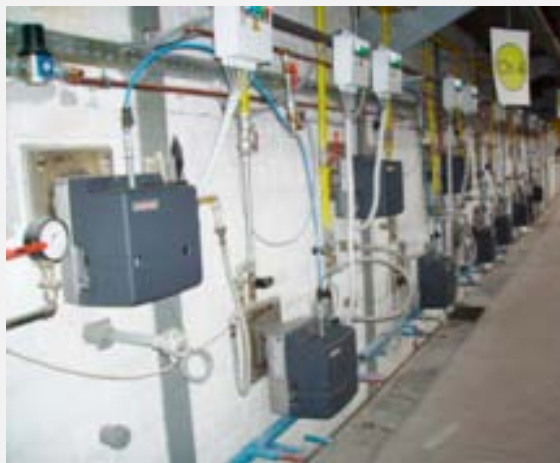
Bild 5: Tunnelofenrekonstruktion mit Gebläseimpulsbrenntechnik.
