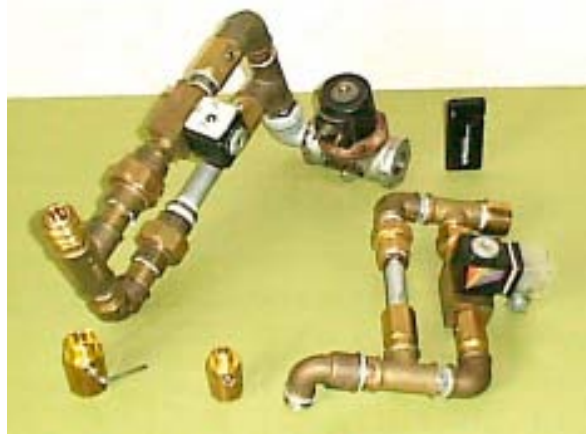
Bild 2a: Impuls Bypass DN6 u. DN10
