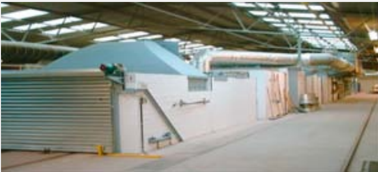
Bild 5: Tunnelofenrekonstruktion mit Gebläseimpulsbrenntechnik.
