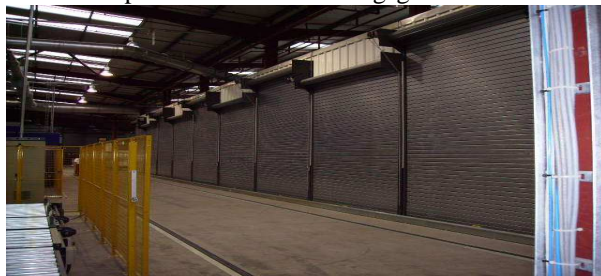
Bild 18. Durchlaufrockner 10 Doppelkammern (schlüsselfertig) für die Polyurethan Industrie zur Prozess-trocknung von Dämmplatten unterschiedlicher Formate u. chem. Zusammensetzung KINGSPAN INSULATION WERK CASTLEBLANEY IRELAND KINGSPAN INSULATION WERK PEMBRIDGE ENGLAND
