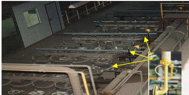
Bild 4. Deckebefuerung mit Impulszonenventil 0-300 Imp./Min. DACHZIEGELWERKE HEISTERHOLZ MINDEN GERMANY
